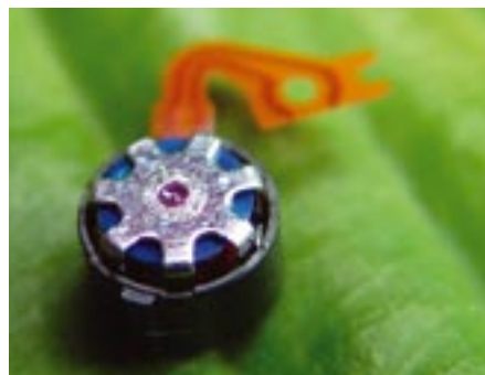
Les partenaires du projet E! 1542 AUTO QUARTZ WATCH ont surmonté les défis techniques considérables liés à la production en masse de microgénérateurs actionnés par énergie cinétique.
